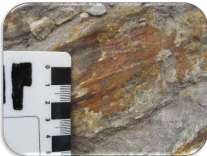
Foto 4. 4. Espejo de falla con estrías en rojo, se desarrolla una amalgama silícea, vereda Sacaneca, Municipio Pachavita.
